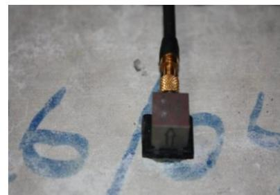
Fig. 2: Accelerometer
